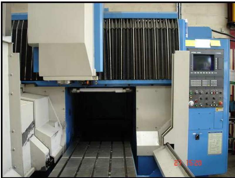
CENTRE D'USINAGE A PORTIQUE HYUNDAI SPTV 32S - CN SIEMENS 840C
