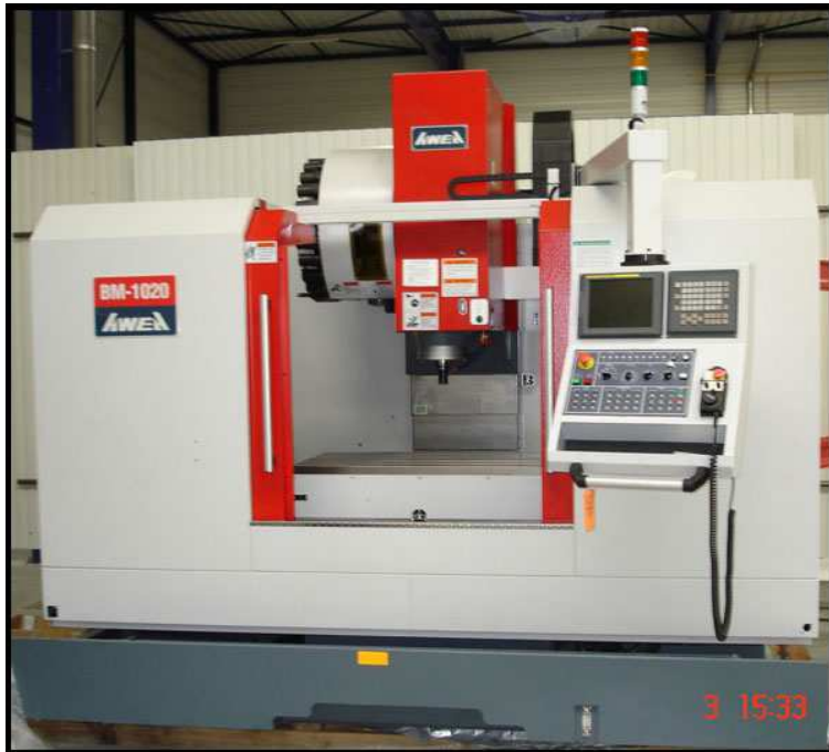
CENTRE D'USINAGE AWEA BM 1020 FANUC 18 de Mai 2008 / course 1020 X 600 X 600
